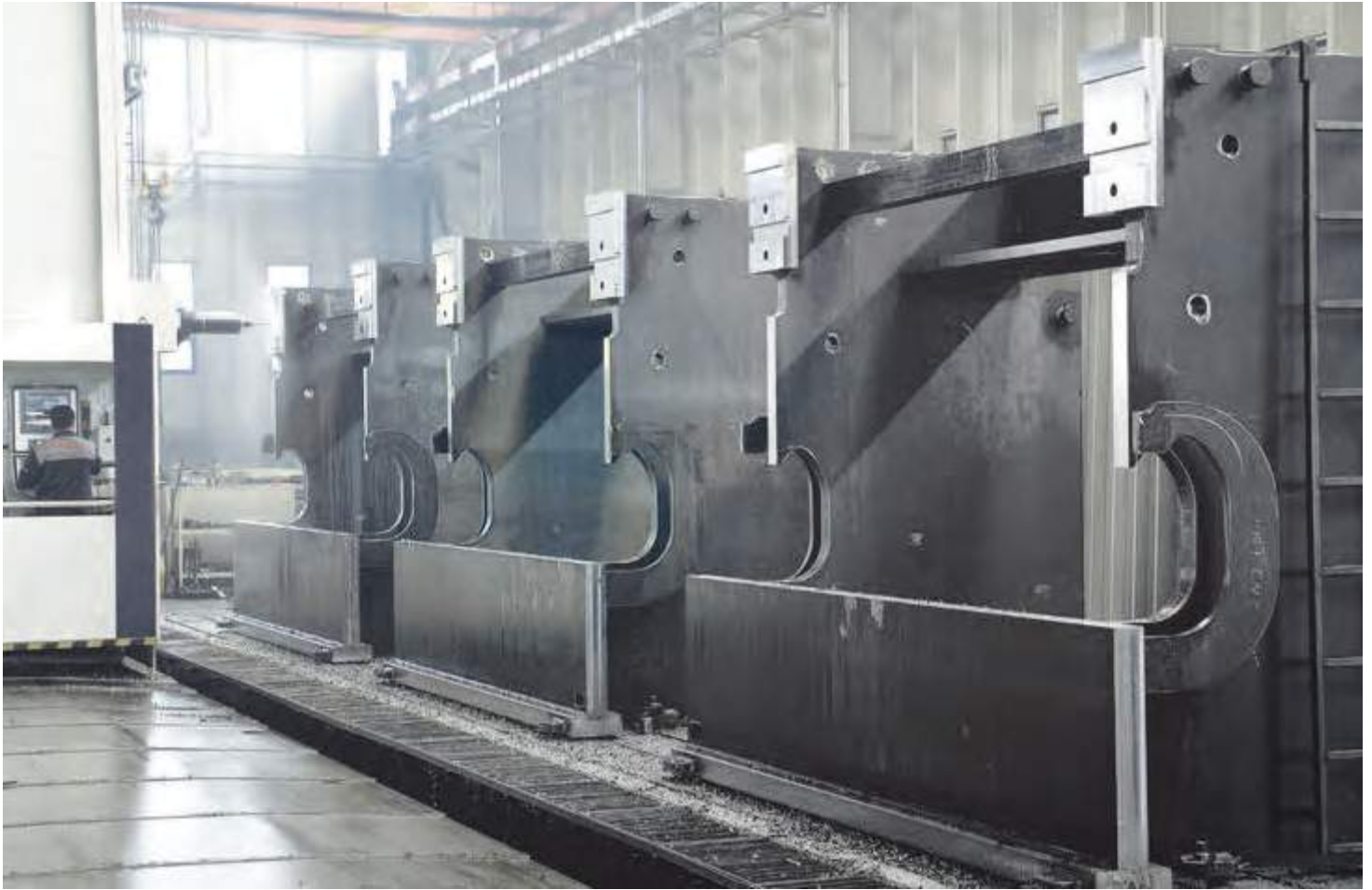
Fresadora de bancada fija columna móvil para mecanizar tándem o trídem de una pasada sin reposición
