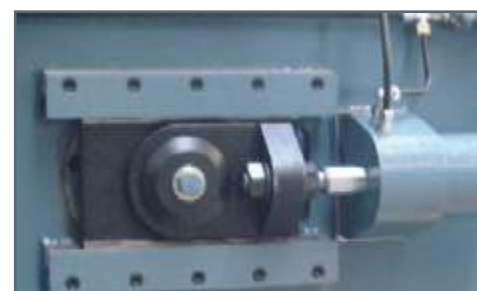
Tensiómetro hidráulico de la hoja (TH)
