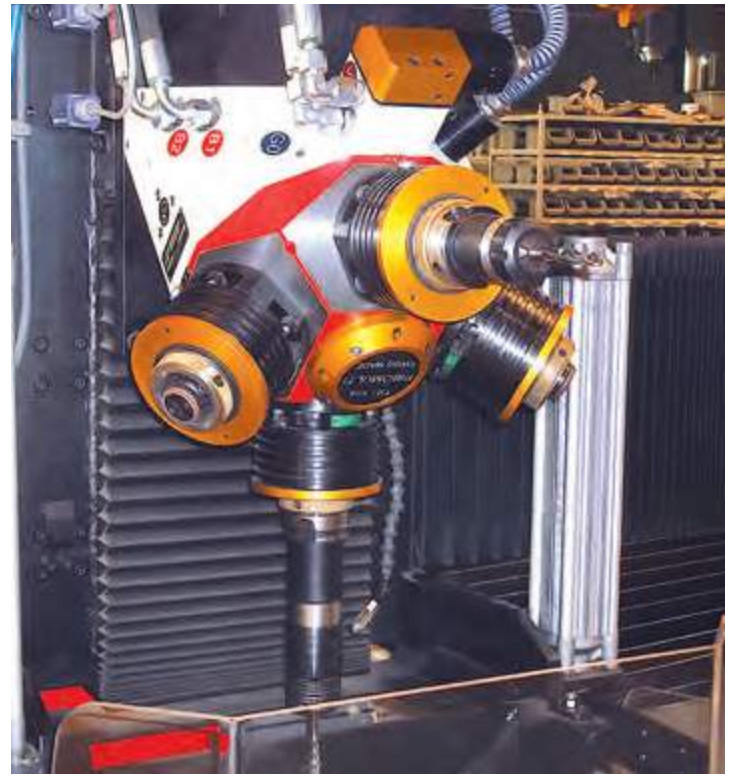
Cabezal de taladrado de 1, 4 y 6 herramientas
