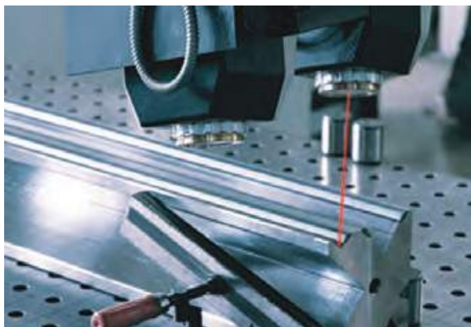
Útiles especiales endurecidos por láser (OPCIONAL)
