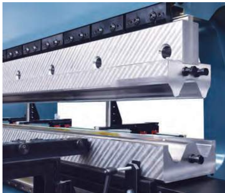
Uillaje especial para plegado de biondas de protección de carreteras
