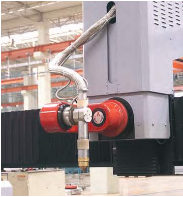
Cabezal de 5 ejes para corte chaflanado
