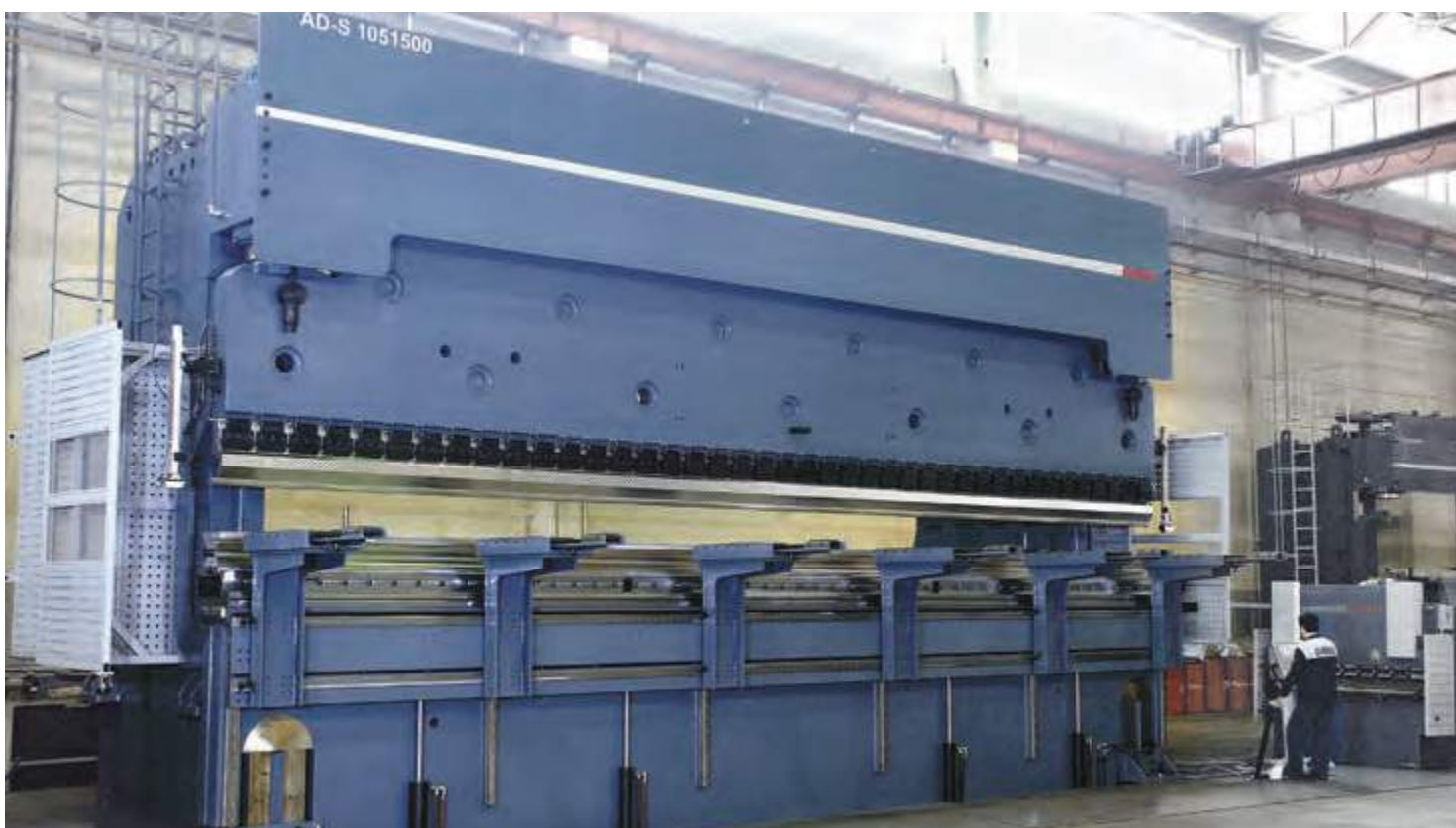
AD-S 1051500 Brazos frontales especiales con elevación motorizada
