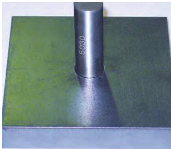
Orificio de corte de 12 mm con tecnología True Hole
