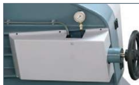
Tensiómetro mecánico de la hoja (TM)
