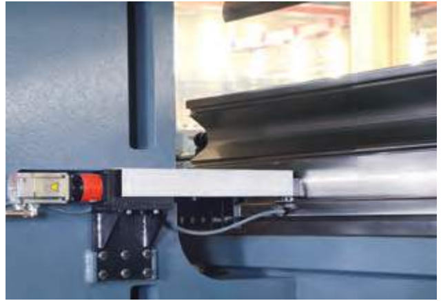
Sistema de posicionamiento motorizado de matriz
