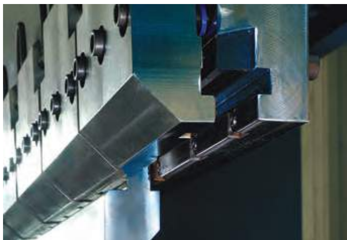
Amarre hidráulico tipo Durma (OPCIONAL) (hasta 500 ton/m)
