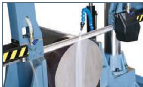
Hojas de sierra bimetálica y sist. de refrigeración de las hojas (SAW)
