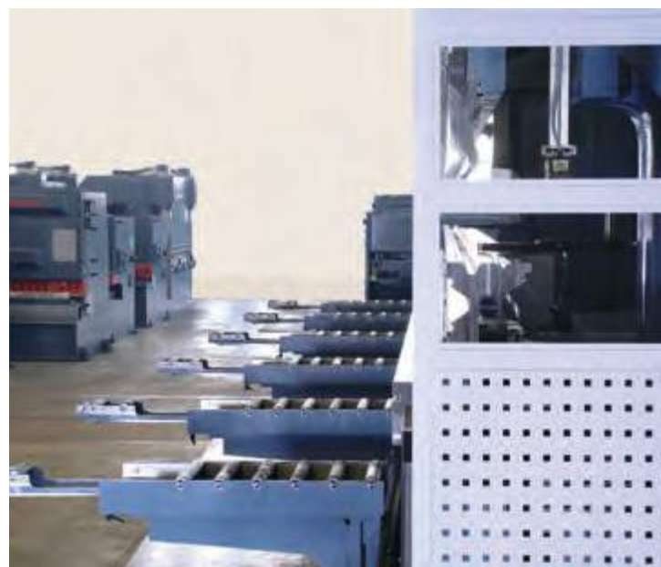
Sistema de brazos frontales con elevación motorizada
