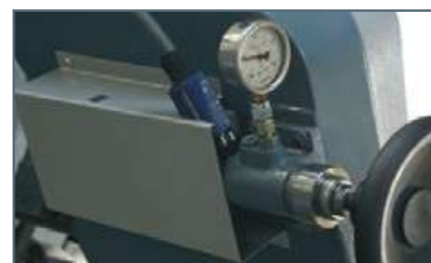
Tensiómetro hidromecánico de la hoja (THM)
