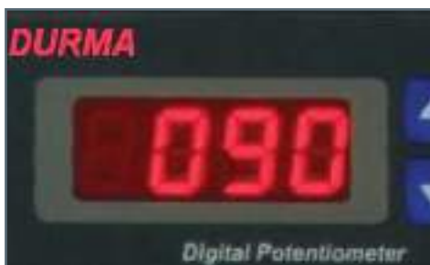
Ajuste electrónico de velocidad de corte con variador (INV)
