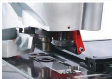
La estación de punzonado en estandar viene equipada con porta-punzón y porta matriz de cambio rápido
