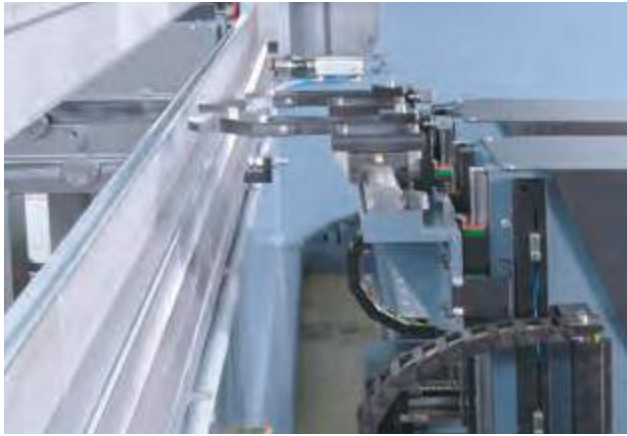
Sistema de posicionamiento neumático de matriz
