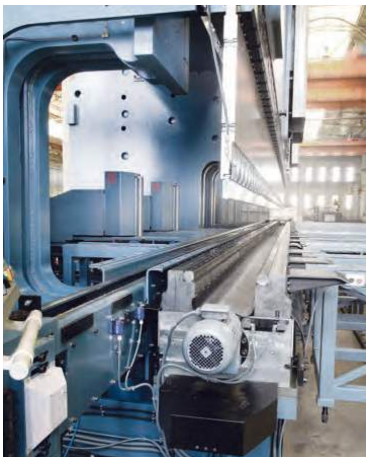
Matriz de apertura motorizada hasta 400 mm. 400 ton/metro
