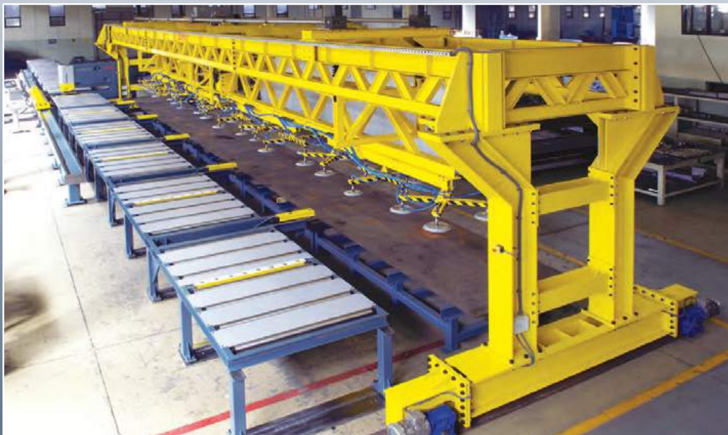
Línea automática de punzonado para báculas y farolas con carga y descarga automática
