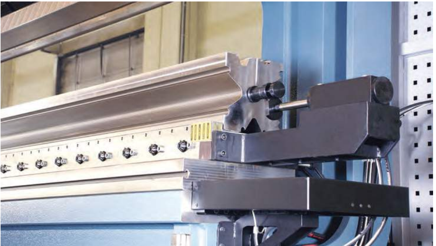
Sistema de movimiento frontal de matriz variable hidráulica programable
