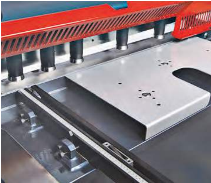
Mesas con bolas para el deslizamiento de la chapa y protección de los dedos
