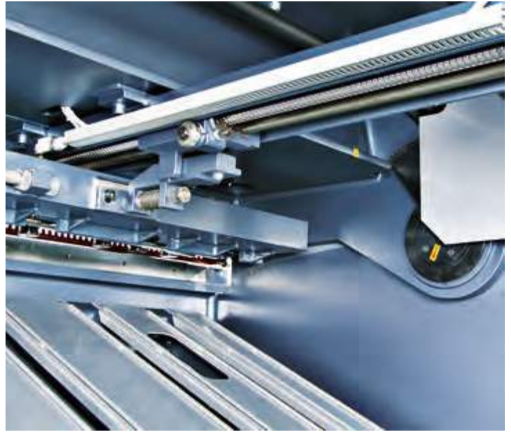
Tope basculante y abatible con guías lineales y husillo a bolas
