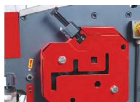
En la estación de cizallado de perfiles se pueden cortar en ángulo gracias a la ejecución especial del útil
