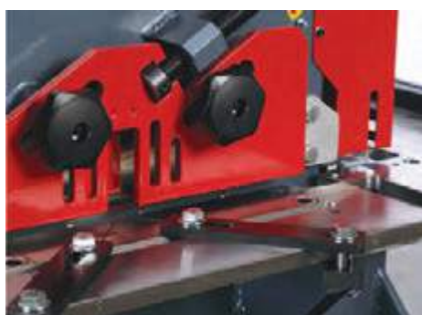
Esta estación permite cortar con cuchillos especiales, redondos, cuadrados, ángulo y muchos otros perfiles especiales bajo demanda
