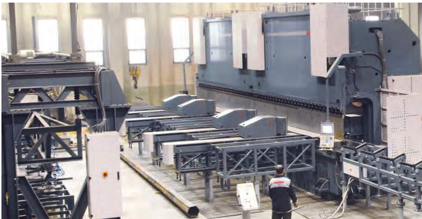
AD-S Tandem 912000 9m 2000 ton X2 Cuellos de 1500 mm.
