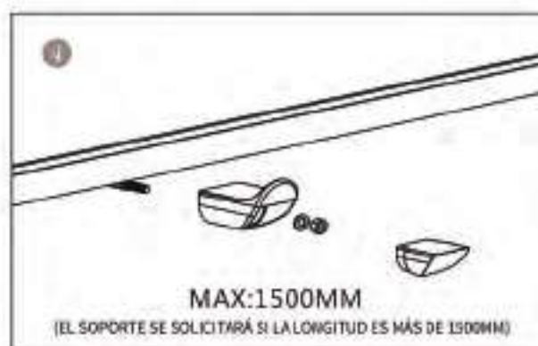
4. Montaje del soporte
