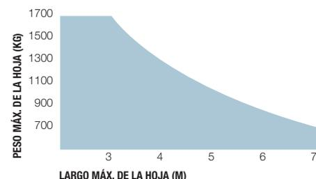
La forma, la altura de la puerta y la presencia de viento fuerte pueden disminuir notablemente los valores indicados en el gráfico.
