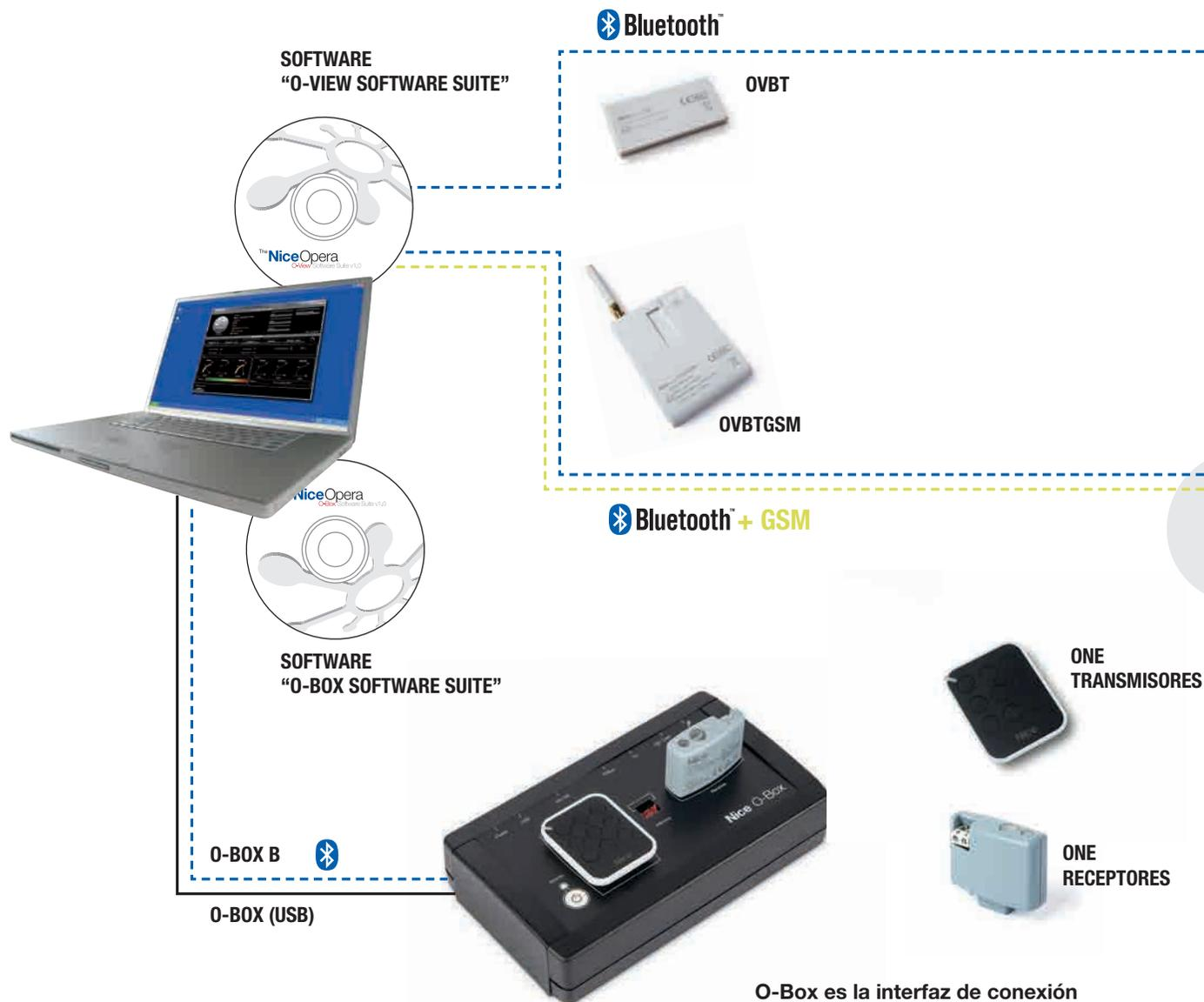
**O-Box es la interfaz de conexión** que, mediante "O-Box Software Suite", permite configurar y programar directamente con un PC o PDA.
