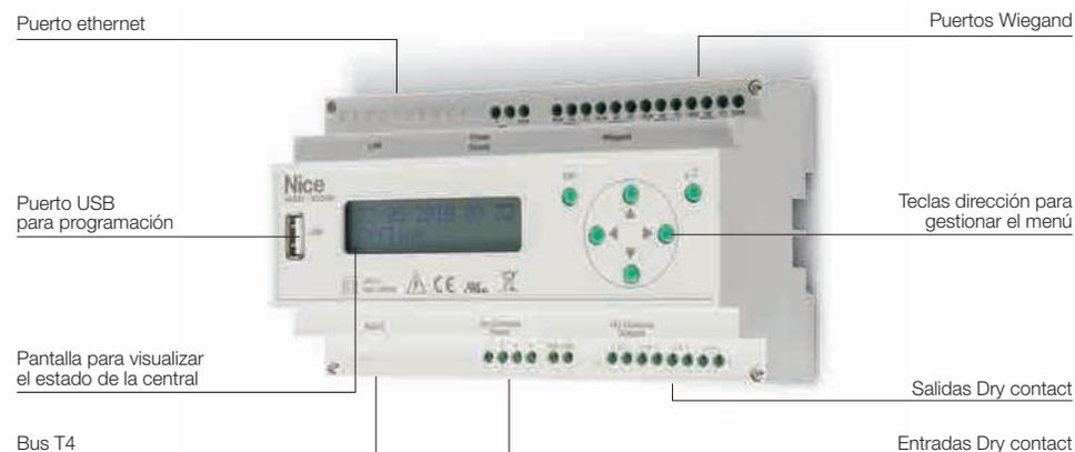
**Módulo DIN para el control de los accesos, equipado con la salida BusT4, 4 puertos Wiegand, 4 entradas dry contact en uso como contactos de entrada y 4 en uso como contactos de salida, puerto ethernet.**
