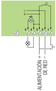
Conexiones para bombillas halógenas o de incandescencia
