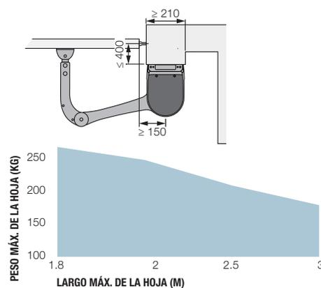
La forma, la altura de la puerta y la presencia de viento fuerte pueden disminuir notablemente los valores indicados en el gráfico.
