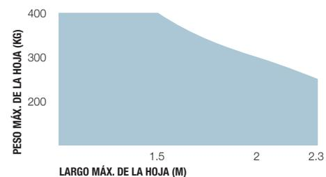
La forma, la altura de la puerta y la presencia de viento fuerte pueden disminuir notablemente los valores indicados en el gráfico.
