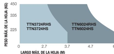
La forma, la altura de la puerta y la presencia de viento fuerte pueden disminuir notablemente los valores indicados en el gráfico.
