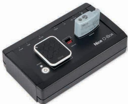
**O-Box es la interfaz multifunción que, mediante el software dedicado “O-Box Software Suite”, permite configurar y programar directamente con un PC o PDA, de una forma sencilla e intuitiva, transmisores, receptores y otros equipos de accionamiento Nice.**
