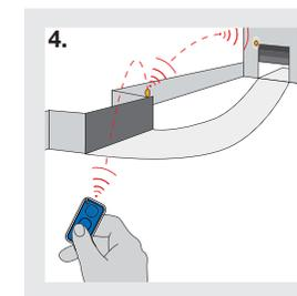
Los receptores OXIT, OX2T y OX4T se pueden usar como repetidores de señal.
