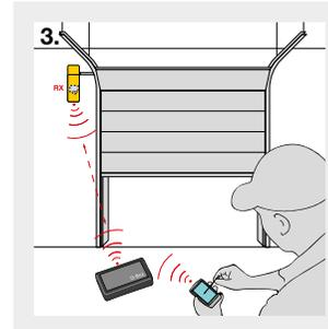
3. La presencia de un "transmisor" internamente en los receptores OXIT, OX2T y OX4T permite acceder a los códigos radio mediante la interfaz multifunción O-Box.
