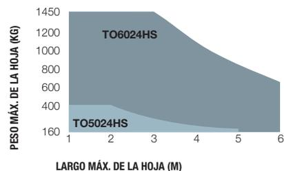
La forma, la altura de la puerta y la presencia de viento fuerte pueden disminuir notablemente los valores indicados en el gráfico.
