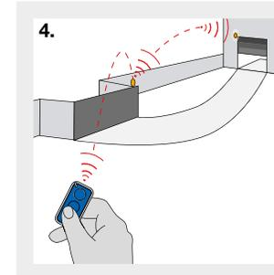
4. Los receptores OXIT, OX2T y OX4T se pueden usar como repetidores de señal.
