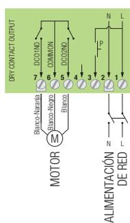
Conexiones de las salidas para motores mecánicos de 3 hilos
