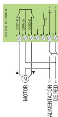
Conexiones de las salidas para 2 switch independientes
