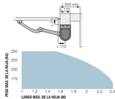
La forma, la altura de la puerta y la presencia de viento fuerte pueden disminuir notablemente los valores indicados en el gráfico.
